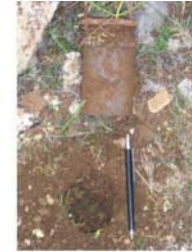
Detalle de un electrodo impolarizable
